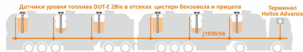
На бензовозах с прицепами число отсеков в цистернах может достигать шести. Поэтому используются датчики DUT-E 2Bio с интерфейсом CAN j1939/S6, работающие по Технологии S6. Все датчики и терминал мониторинга Helios Advance организованы в единую шину с общим питанием и настройкой всего оборудования из одной точки. Каждый датчик имеет уникальный адрес в сети. Это позволяет перевозчику видеть как общий объем топлива в бензовозе и прицепе, так и уровень и объем топлива в каждом отсеке.
