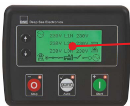
Controlador DSE 4510, visualización de los parámetros de funcionamiento en pantalla
