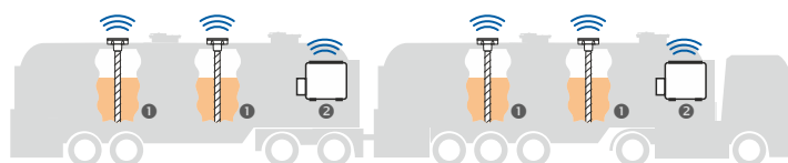
Composition du système de surveillance : ① capteurs de niveau DUT-E 2Bio S7 ② terminal Teltonika avec l'interface Bluetooth
