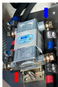
Izquierda: Medidor de flujo DFM D S7 conectado a las líneas de suministro (→) y retorno (←) de combustible
