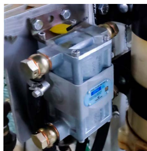
Débitmètre DFM 250D S7 installé à bord
