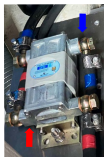
Gauche : débitmètre DFM D S7 connecté aux conduites de carburant d'alimentation (→) et de retour (←)
